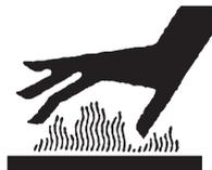
Questo simbolo previene l'utente sulla presenza di temperature elevate che possono provocare ustioni gravi. Alcune superfici si possono avvicinare ai 200° C. (392 °F.).
